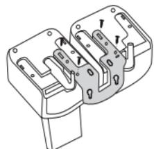
L'armature métallique sous les chargeurs est démontable et peut être utilisée pour assembler deux chargeurs entre eux (voir figure). Cet assemblage peut également être fixé sur une surface verticale, contacter votre installateur
