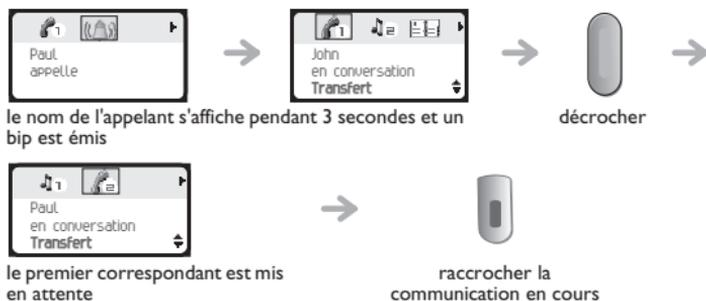
*Au delà de 3 secondes, se déplacer avec la touche naviguer-gauche-droite jusqu'à l'icône réception second appel, pour voir l'identité du second appelant (et décrocher, si nécessaire)*
