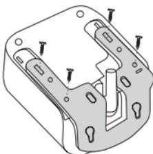
L'armature métallique sous les chargeurs est démontable et vous permet de fixer le chargeur sur une surface verticale (voir figure), contacter votre installateur
