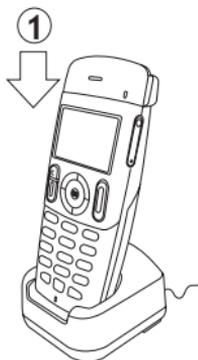
Connecter le chargeur et placer le téléphone dans le support de charge. Le voyant du téléphone est vert en cours de charge.
